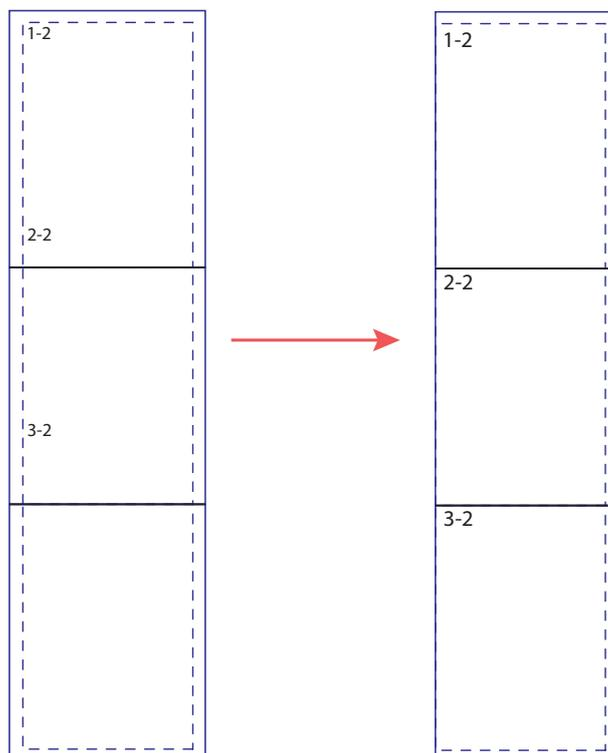
**4. Cole a lateral direita da segunda coluna na linha pontilhada esquerda da primeira coluna e assim em diante com todas as "X" colunas.**
